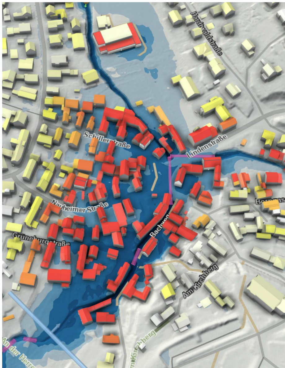
Abbildung 3.9: Visualisierung der Wassertiefen 120 min nach Regenbeginn im Bereich des Bissenbach vor der Bahnunterführung für das RADKLIM-Szenario
