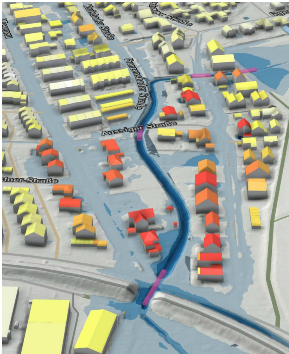
Abbildung 3.6: Visualisierung der Wassertiefen 120 min nach Regenbeginn im Bereich des Bizenbach vor der Bahnunterführung für das RADKLIM-Szenario
