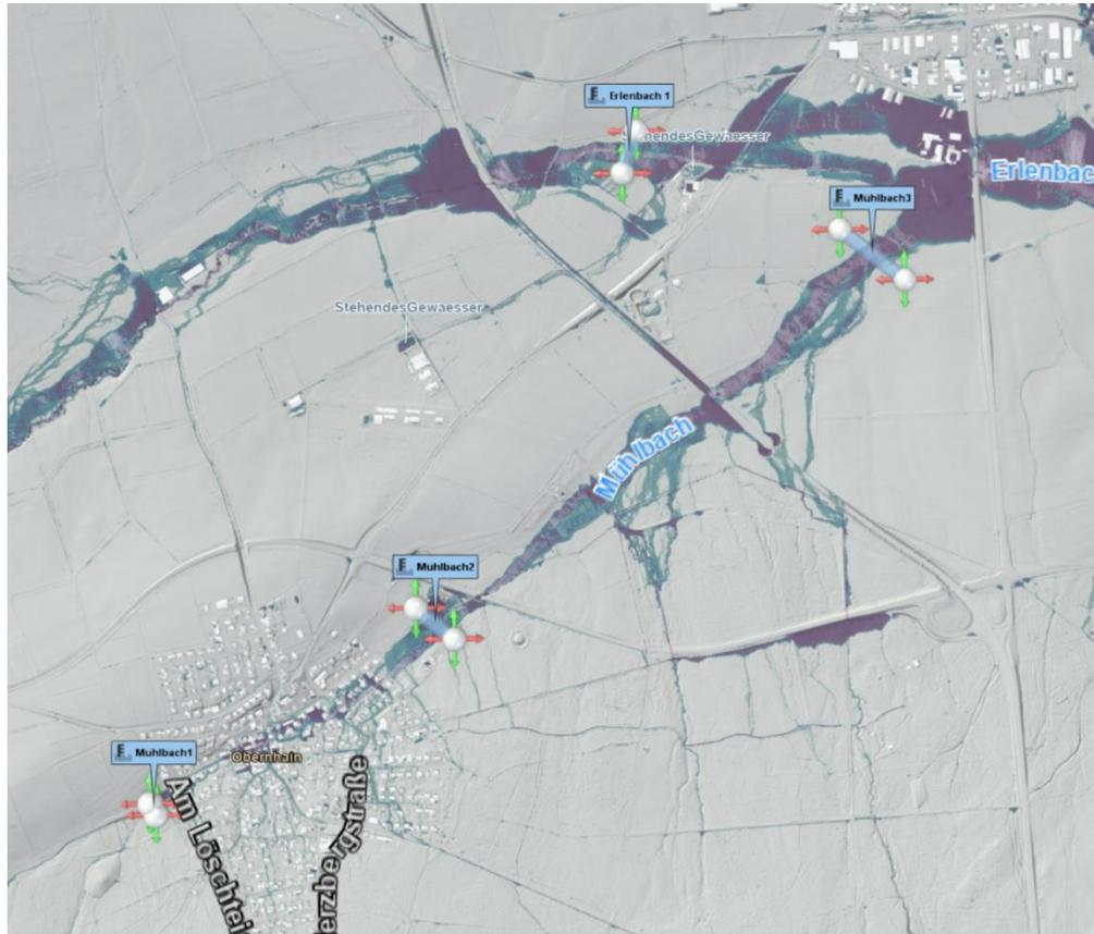
Abbildung 6.3: Kontrollquerschnitte für das Szenario Oberhain
